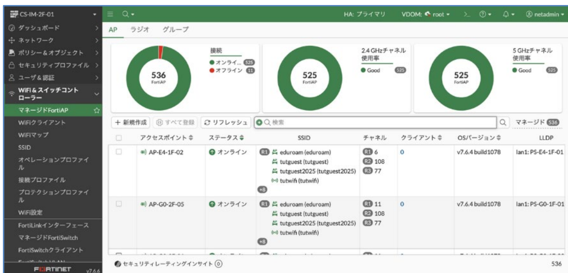
図 10. 無線コントローラの管理画面
