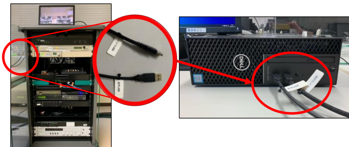
図2 天吊りカメラ映像と教室音声のUSBケーブルを教員用PC（第1端末室）に接続
